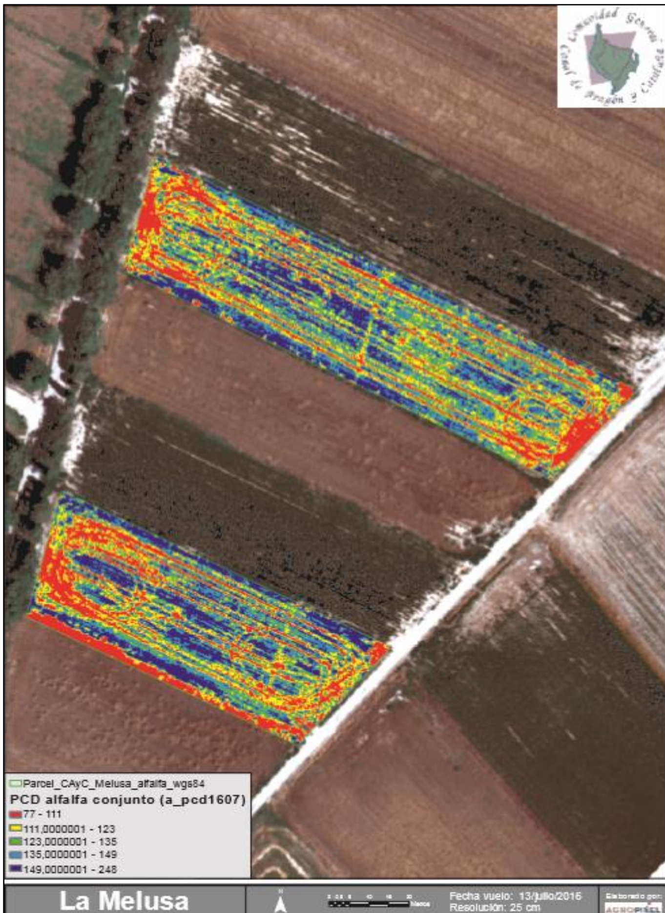
Figura 4. Ortofoto con índice PCD aplicado en las parcelas de alfalfa regadas mediante sistema RGS (fuente: Agropíxel, S.L).
