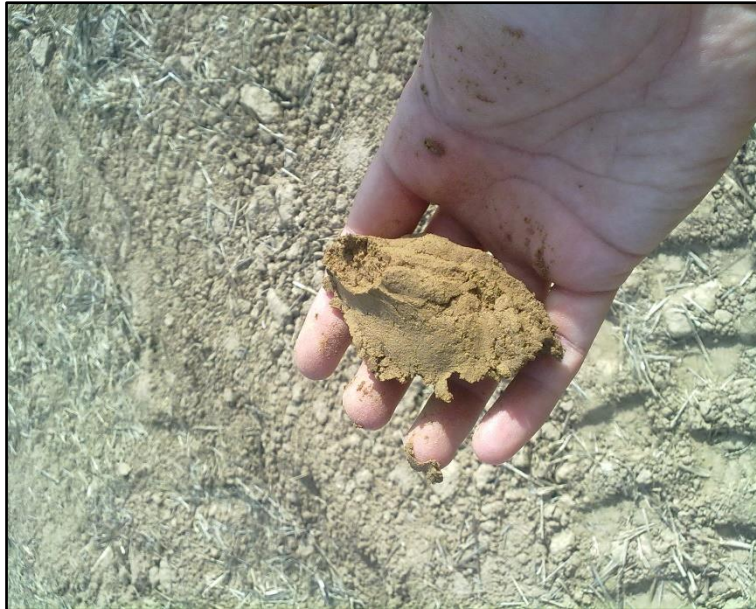
Figura 11. Determinación manual de la textura y consistencia del suelo de las parcelas del ensayo.
