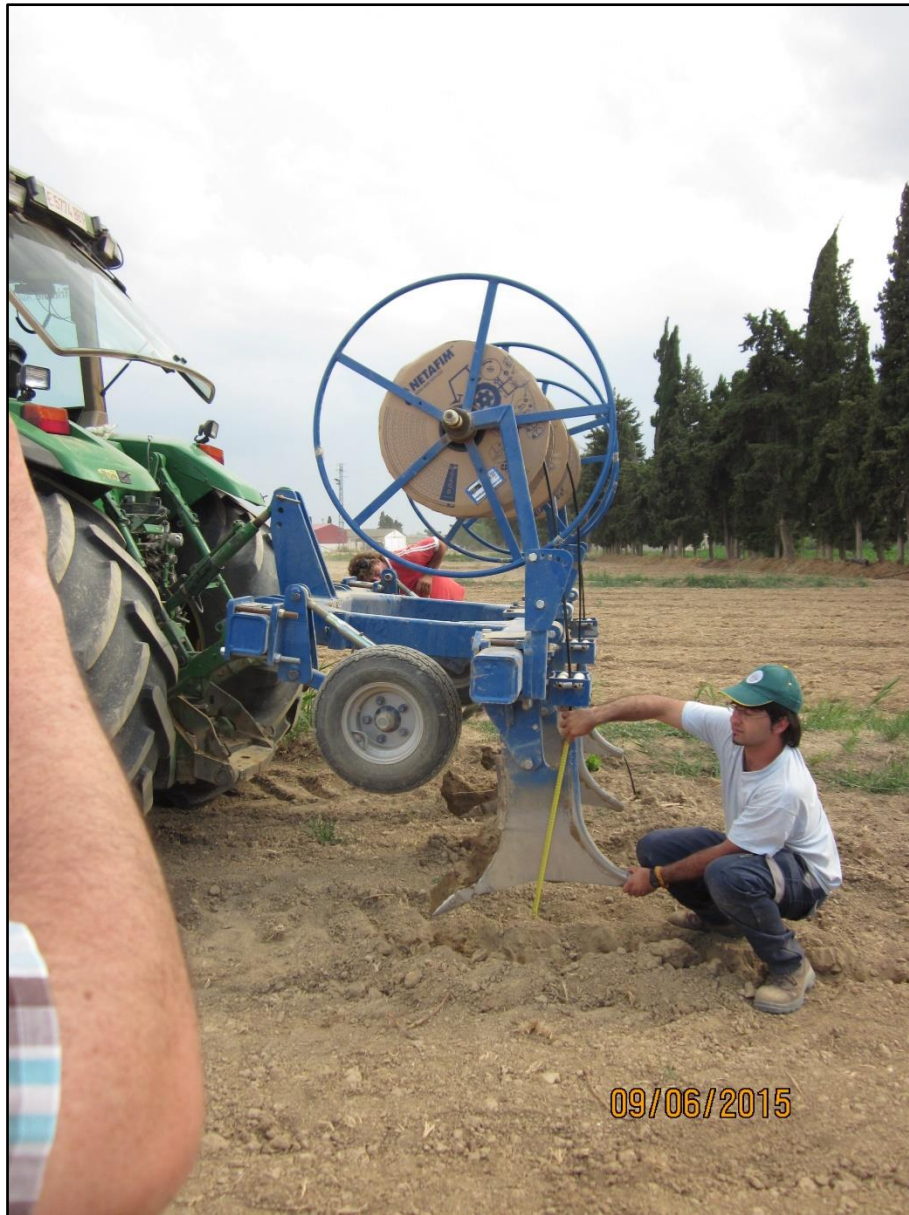
Figura 14. Comprobación de la profundidad de instalación de la manguera.
