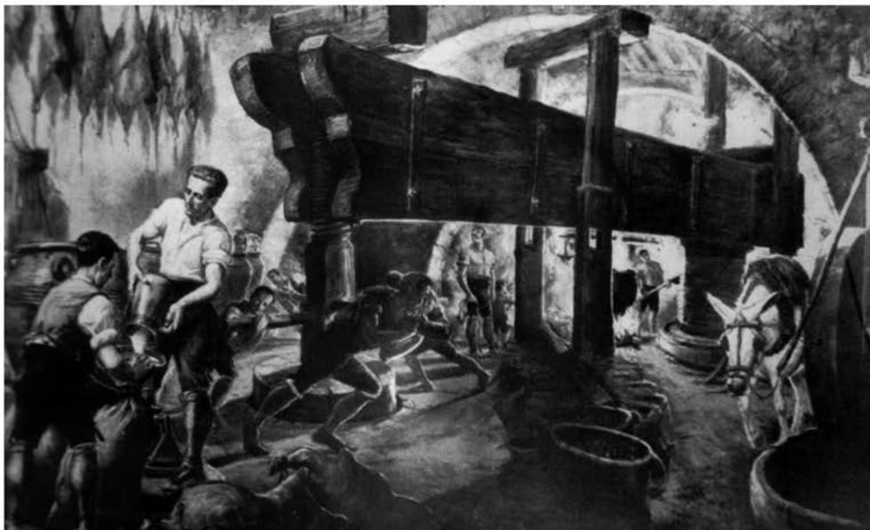
Lámina 1. Antiguos grabados mostrando a molinos aceiteros en pleno funcionamiento. Arriba: con prensa de rincón (J. Stradanus, s. XVI-XVII). Abajo: con prensa de viga y quintal (siglo XVIII). Plate 1. Old engravings that show the oil mills in full operation. Above: with corner press (J. Stradanus, 16 th -17 th century). Below: with beam and quintal press (18 th century).
