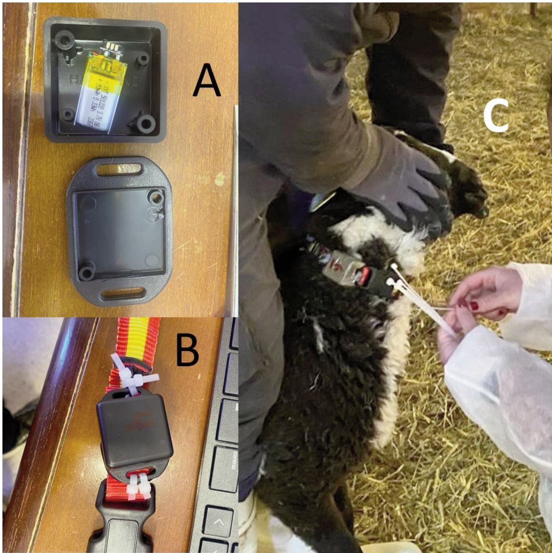
Figura 1. Sensores de proximidad móviles dotados de tecnología Bluetooth Low Energy (0.9 g) (A) usados en el experimento, protegidos en el interior de una caja de plástico (35 x 35 x 10 mm) (B) e insertadas en un collar (C).
